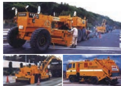
1978 (昭和53年) 路面切削機
