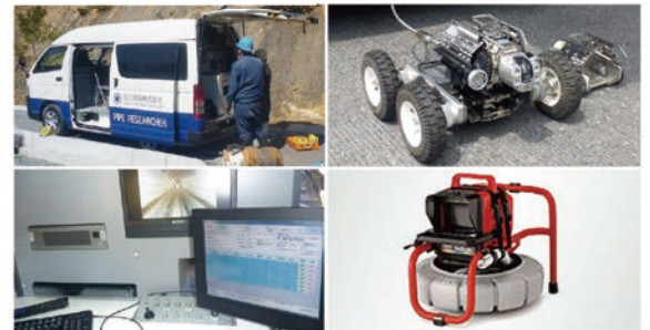
1994 (平成6年) 下水道管路調査 テレビカメラ
